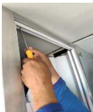
Figuras 03 e 04: Retirada e tentativa de reparo no trilho da porta interna do onibus de coleta da unidade;
