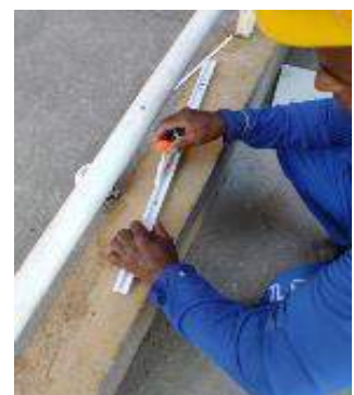
Figuras 03 e 04: Retirada e tentativa de reparo no trilho da porta interna do onibus de coleta da unidade;
