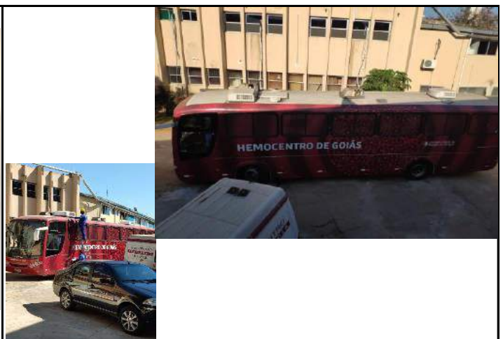
Figura 05 e 06: Retirada dos protetores de condensadora do ar condicionado do ônibus para posterior manutenção.
